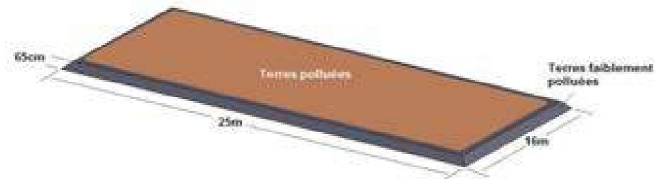
Figure 36- Montage de la première couche d'une pile de 800 m<sup>3</sup>
