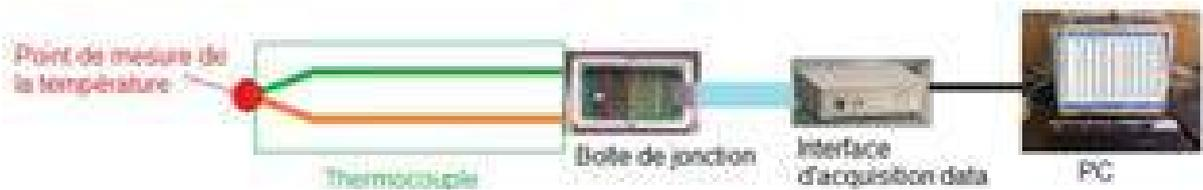
Figure 45- Connexion d'un thermocouple
