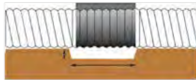
SCHEMA D'UN DÉCAISSEMENT SOUS COLLIER
